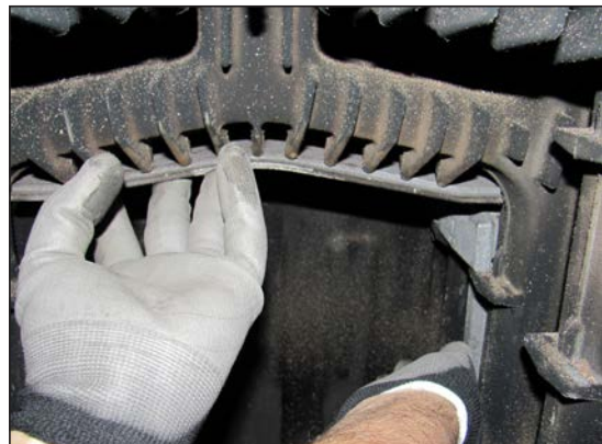
Рис. 5 2-й дефлектор с передними боковыми опорами
