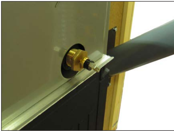
Fig. 9 Termostato de seguridad
